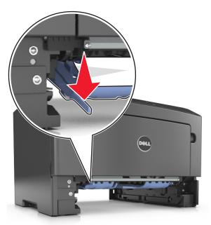
**Hinweis:** Falls das gestaute Papier im Duplexbereich nicht zu sehen ist, öffnen Sie die hintere Klappe und ziehen das gestaute Papier vorsichtig heraus. Stellen Sie sicher, dass alle Papierteile entfernt werden.
