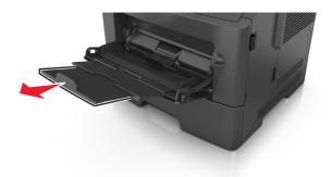
2 Drücken Sie den Hebel an der linken Breitenführung zusammen und schieben Sie die Führungen an die für das eingelegte Papier vorgesehene Position.
