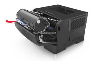
**3** Heben Sie den blauen Hebel an und ziehen Sie dann die Belichtungseinheit aus dem Drucker heraus.
